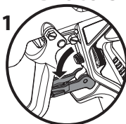
Abzug verriegelt (Spritzpistole sprüht nicht)
